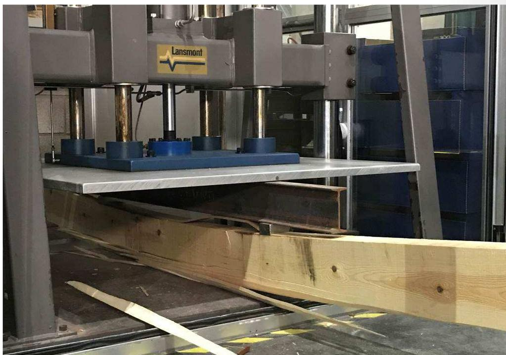
*Imagen 5. Rotura de una viga de pino silvestre en el ensayo de flexión según la norma UNE EN 408.*
