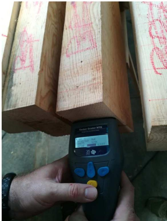
*Imagen 4. Evaluación no destructiva de la resistencia mecánica de las vigas mediante tecnología de vibraciones inducidas/ondas de presión.*
