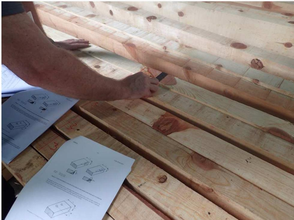
**Imagen 1. Inspección según criterios visuales: ubicación y medida de los nudos relevantes por tamaño en las vigas. A partir de estas medidas se calcula el índice CKDR**
