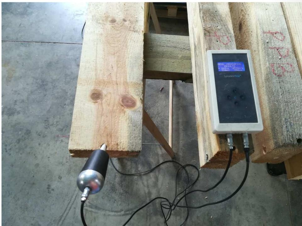
**Imagen 2. Evaluación no destructiva de la resistencia mecánica de las vigas mediante tecnología de emisión-recepción de ultrasonidos.**
