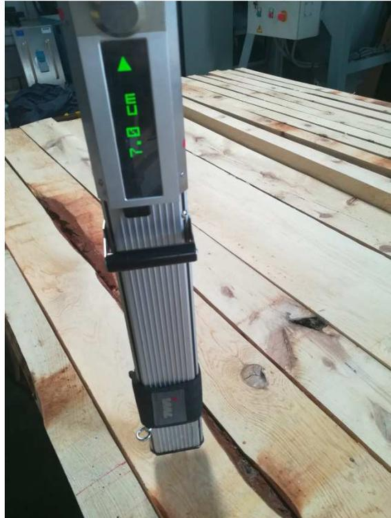
*Imagen 3. Evaluación no destructiva de la resistencia mecánica de las vigas mediante tecnología de resistografía.*
